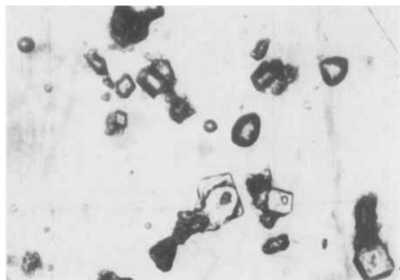
PHOTOGRAPHIE Formation de Cd(H 2 PO 4 ) 2 · 2H 2 O à partir de Cd 3 (P 3 O 9 ) 2 · 14H 2 O en transformation
